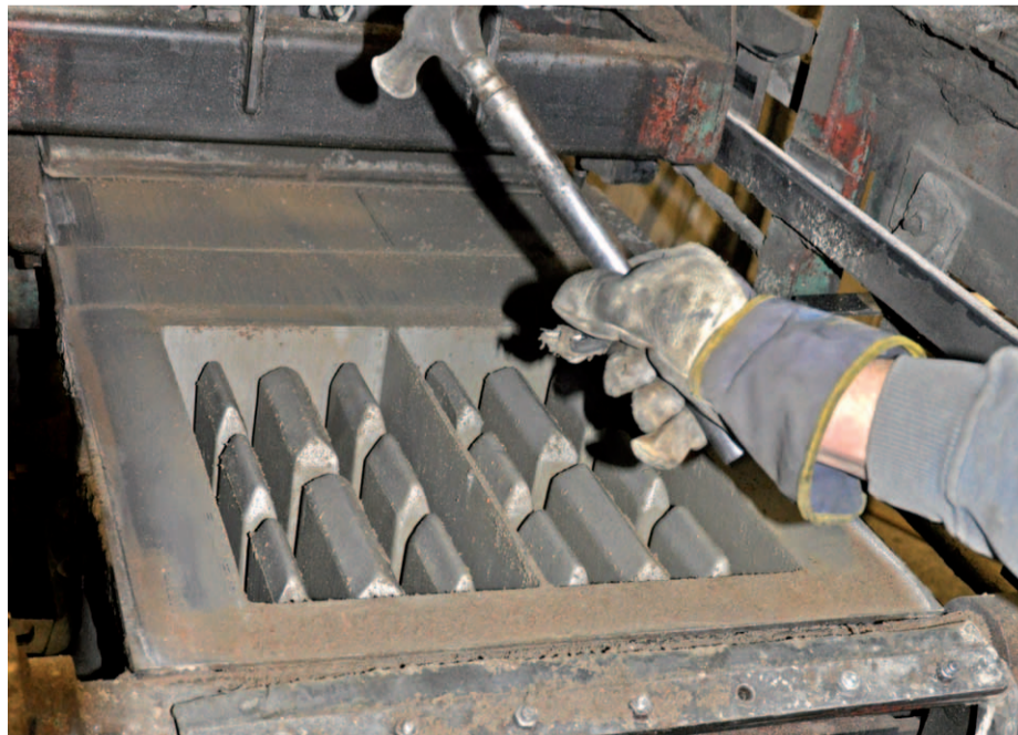
Slitaget vid gjutningen är inte alldeles obefintligt. Man räknar med att till sommaren få montera en ny gjutform.
